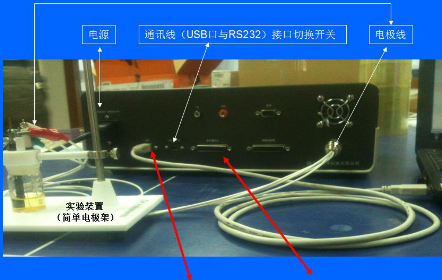
CHI电化学工作站 连接示意图
